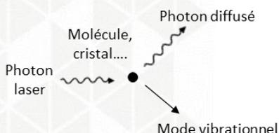
Par simple comparaison entre l'énergie du photon diffusé et du photon incident on détermine l'énergie (donc le nombre d'onde) du mode vibrationnel.
